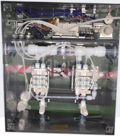
スラリー希釈供給装置 (Slurry Supply)
